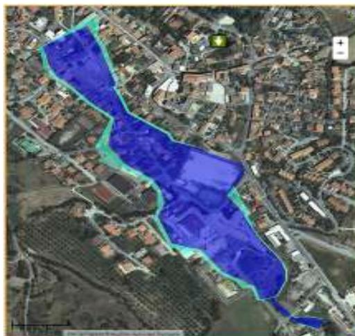
Fig. 5 – Estratto cartografia del P.A.I. - Pericolosità idraulica Hi4 - Molto elevata
