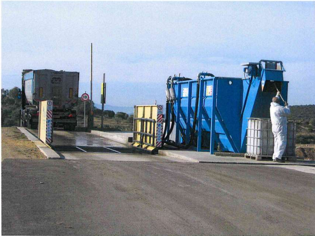
Figura 9: Impianto lavaggio mezzi
