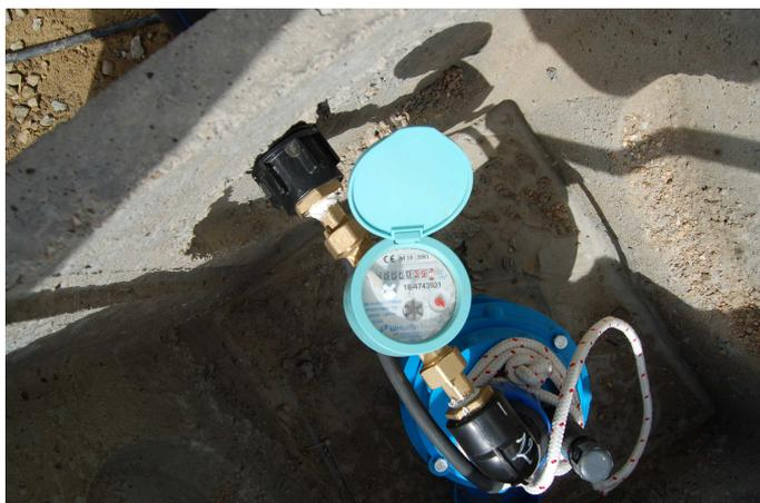
Foto 2 - flussometro piezometro P12 (valore riportato 0,39 m<sup>3</sup>)
