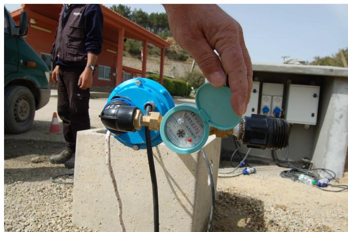
Foto 3- flussometro piezometro P12bis (valore riportato 52,205 m<sup>3</sup>)
