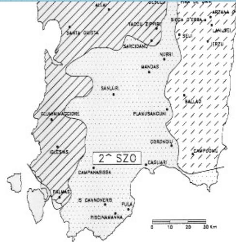
Figura 19 – Sotto Zone Omogenee per le piogge brevi e intense in Sardegna. In ciascuna zona i parametri del modello TCEV sono riportati in Tabella 8. (da Deidda ed. al., 1993)
