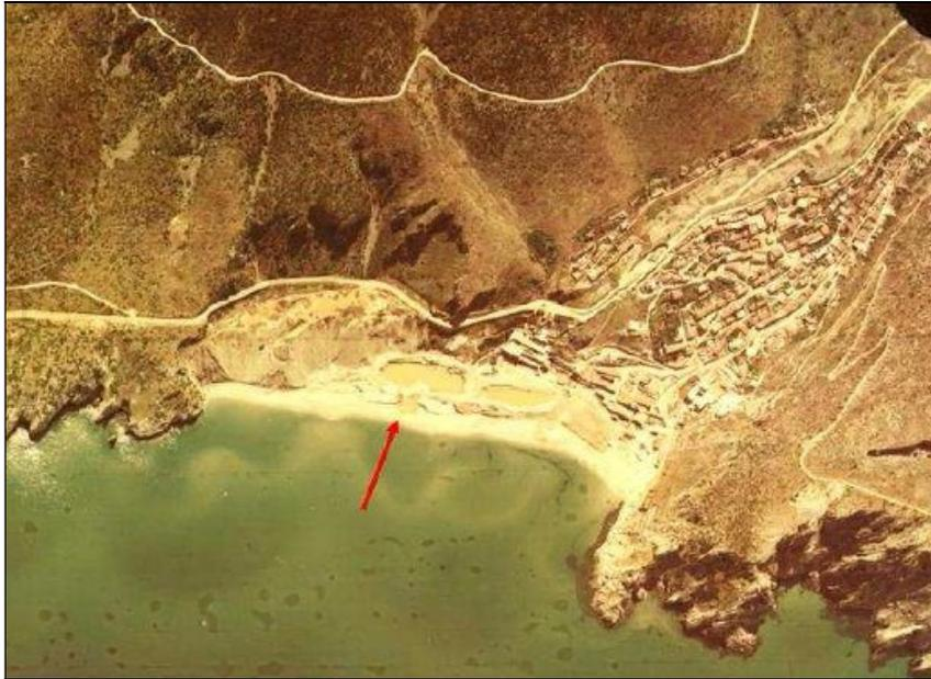
*Foto 2 – Spiaggia di Buggerru occupata dagli sterili di flottazione con indicazione della rottura dell'argine e il conseguente riversamento a mare dei fini*
