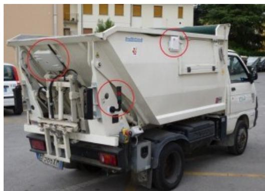
Figura 6. Antenne di lettura dei transponder a bordo mezzo
